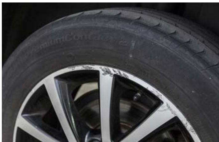
Diepe krassen op aluminium velgen die groter zijn dan één vierde van de omtrek van het wiel kunnen niet door de beugel
