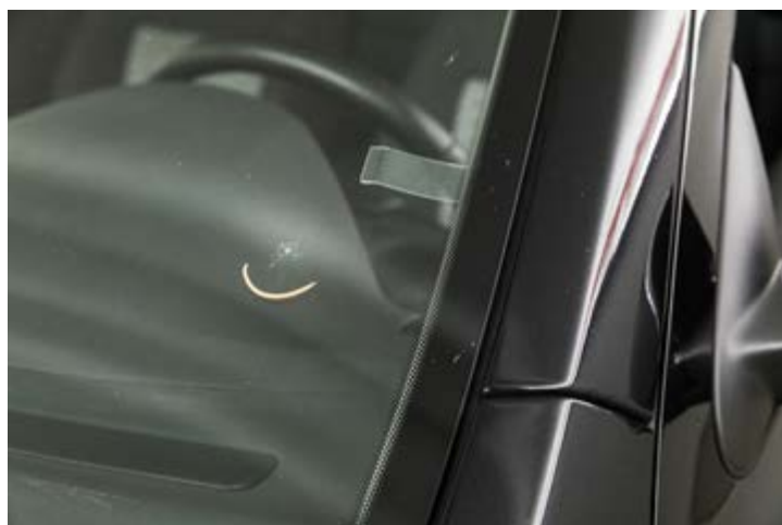
Met dergelijke glasschade kom je zelfs niet door de keuring
