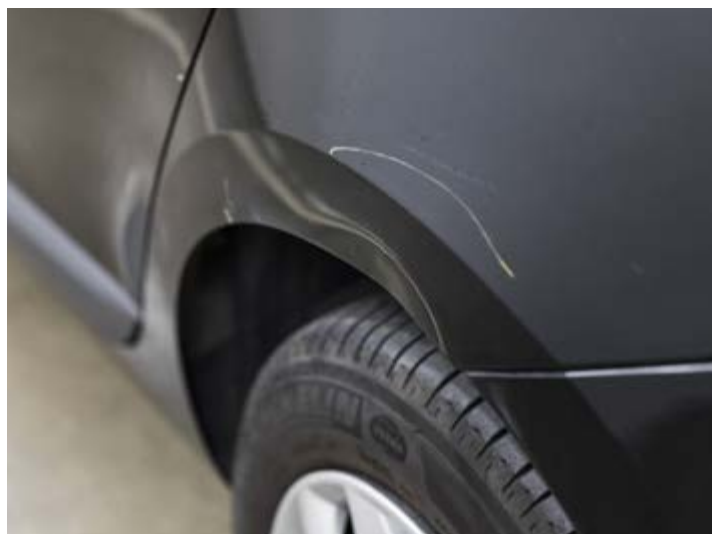
Ook niet aanvaardbaar zijn diepe deuken die groter zijn dan een stuk van 1 Euro.
