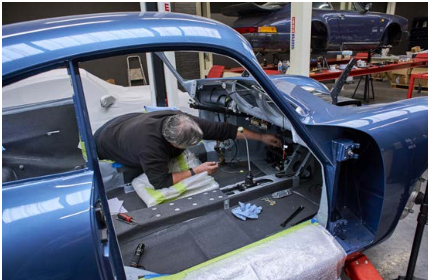
De meest tijdrovende bezigheid is het opnieuw monteren en aansluiten van de kabelbomen.
