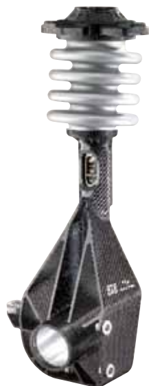
Les jambes de suspension renforcées de fibres permettent de réaliser une économie de poids de 50 % par rapport à l'aluminium.
