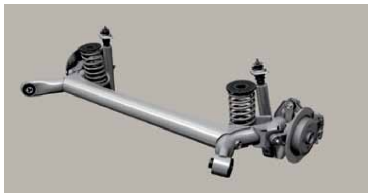
Le « Multicompliance Twist Beam » permet une direction arrière passive.
